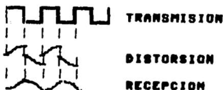
FIG.1.1 Transmisión en banda base.
