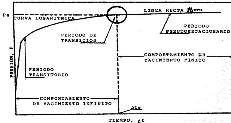
FIG. III.2 COMPORTAMIENTO TÍPICO DE LA VARIACION DE LA PRESION EN FUNCION DEL TIEMPO DE CIERRE EN UN POZO PRODUCTOR DE ACEITE.
