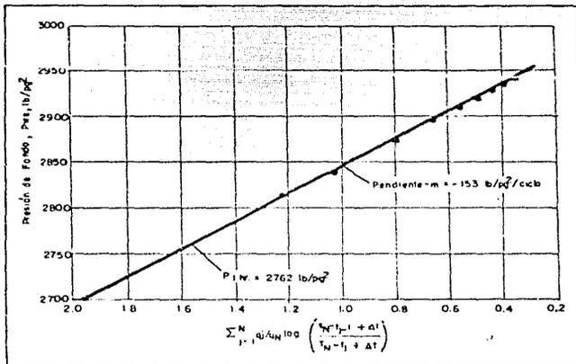
Datos graficados para determinar la pendiente de la recta y el valor de P1/W. Posteriormente esta información se introduce al programa para obtener el valor del factor de daño y permeabilidad.
