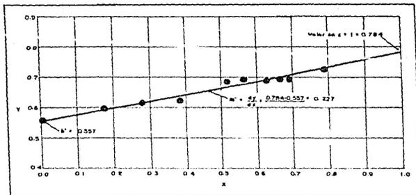
Valores de x, y graficados, para una prueba de decremento con gasto variable. Después de la determinación de la pendiente y los puntos de intercepción de la línea, esta información se introduce al programa para obtener el valor de la permeabilidad.
