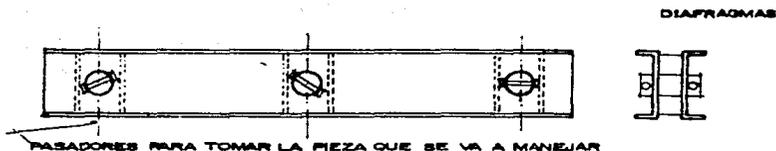
Viga equilibradora (esquema típico). Puede invertirse, para que dos piezas de equipo pueden izar una pieza en el centro.
