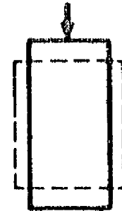
Espécimen sometido a una deformación vertical importante (15%)
