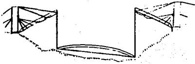
Procedimiento de Cantiliver ó Voladizo
