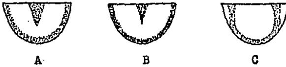
Fig. 1. Representación esquemática del stress de flexión y deformación en las valvas de las bioprótesis. A, B y C zona de flexión de prótesis de Carpentier, Hancock y Ionescu respectivamente.
