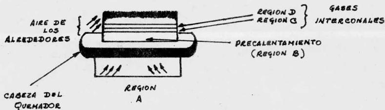
Los gases emergen de la región A, pasan a la región B, de aprox. 1.0 mm de espesor, en la cuál son calentados por conducción y radiación de la zona de reacción C y por difusión de radicales dentro de ella; éstos inician la oxidación.
