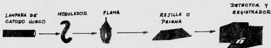
a).- Lámpara de cátodo hueco. Consta de dos electrodos, uno de los cuáles tiene forma cóncava (cátodo) y está constituido por el elemento especificado (ó una aleación de ese elemento). El ma-
