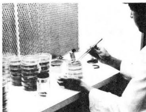
Fig. 3. Exposición de los bloques de prueba al ataque del hongo en la técnica de malta agar-bloque.
