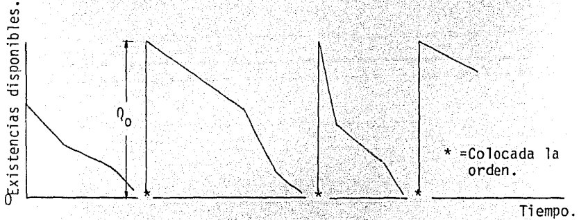
GRAFICA 2.- SISTEMA DE TAMAÑO DE PEDIDO FIJO, TASA DE UTILIZACION FLUCTUANTE, TIEMPO DE DEMORA CERO.
