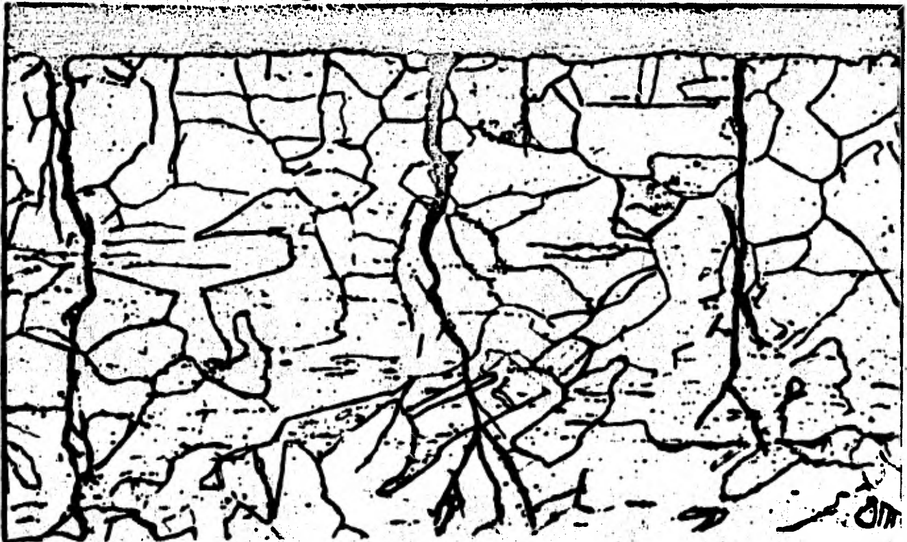
Fig. 8 Agrietamiento transcristalino por co - rrosión bajo esfuerzo en un acero inoxidable austenítico tipo 304.
