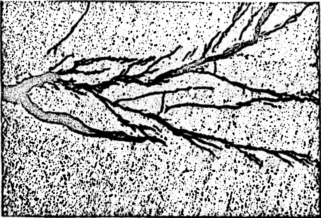
Fig. 9 Agrietamiento transcristalino por corrosión bajo esfuerzo.
