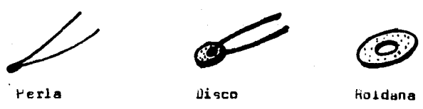
Fig. 3.4. Forma de los termistores en que pueden obtenerse.
