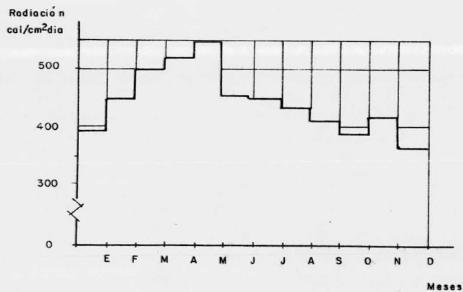
Fig.2.5.B Promedio de radiación recibida, cal/cm² día- mes valor medio anual 463 cal/cm² día- mes
