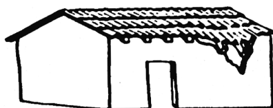
Fig 7 Falla local por empuje de las vigas en muros de piedra y lodo
