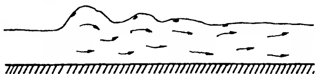
F de 1.0 a 1.7-Salto hidráulico ondular
