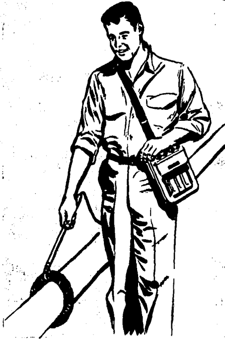
Detección de fallas en el Revestimiento de la tubería, empleando el Detector - Eléctrico.
