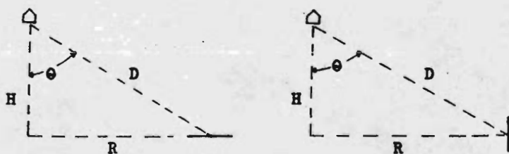
Fig.16. Iluminación horizontal y vertical bajo fuentes puntuales.
