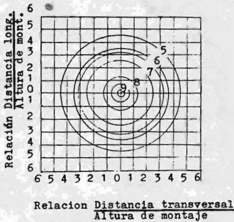
Fig. 19. Diagrama isolux de un luminario de alumbrado público.
