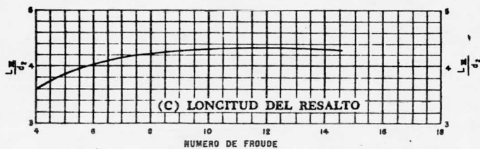
Fig. 4.33 Características para los tanques con No. de Froude mayor de 4.5 y velocidad mayor de 15 m/seg. [Ref. 3]
