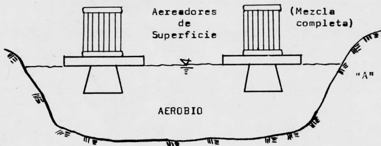
FIG. II-3.- DOS TIPOS DE LAGUNAS DE ESTABILIZACION AEREADAS
