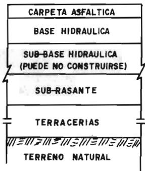
SECCION ESTRUCTURAL CON PAVIMENTO FLEXIBLE (USUAL)
