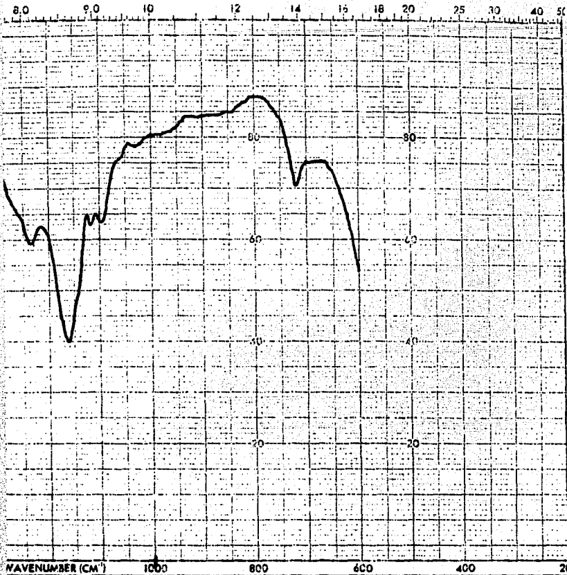
Fig. 10 ESPECTRO EN EL INFRAROJO DEL ACEITE DE SALVADO DE ARROZ DEL PRIMER FULIDOR
