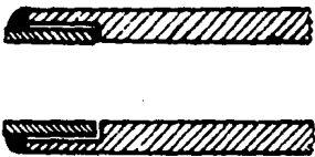
Figura 2.17 Unión soldada a profundidad.
