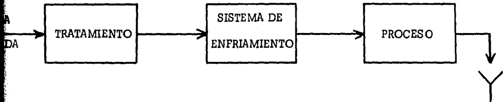
Figura 3.1 Sistemas Abiertos de un Solo Paso.
