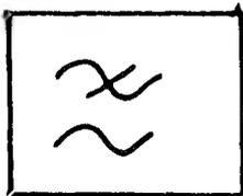
Es un filtro LC que limita la banda de frecuencias de la señal entrante al valor normalizado de 3400 Hz. El filtro elimina los componentes de C.D. a la salida.
