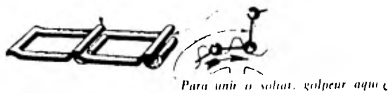
Fig. 6-11 Cadena de eslabones de gancho, hecha de acero estampado.
