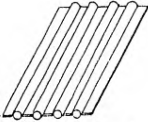
Fig. 27 Calentador de agua con tubos formados hidráulicamente.
