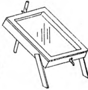
Fig. IV.20 Bandeja calentadora de agua inclinada con cubierta de vidrio.
