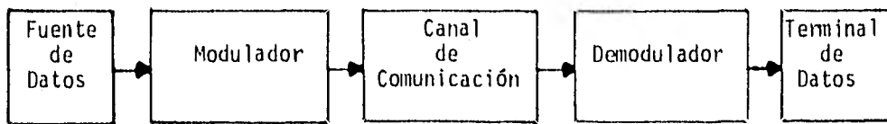
fig 2.1 Modelo de un sistema de transmisión de datos.
