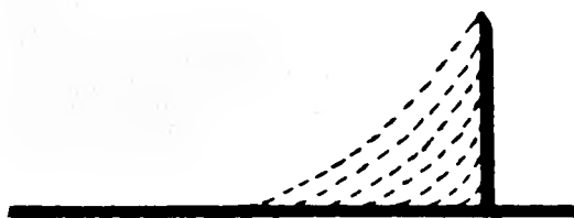
Fig 4.2 Perfiles contorneados con mastique hasta obtener uno casi fluidodinámico.
