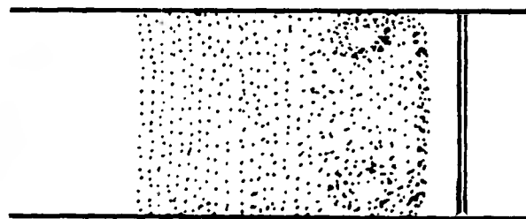
Fig 2.18 Proceso del barrido de arena de dos zonas ovales (zona de vórtices erguidos) y una franja transversal
