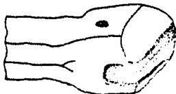
Fig. 8-3 Barrena tipo cincel
