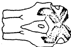
Fig. 8-5 Barrena de inserto múltiple.
