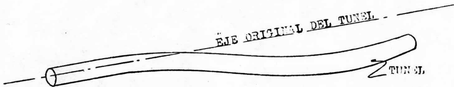
Fig V-5 SERPENTEO DEL TUNEL.
