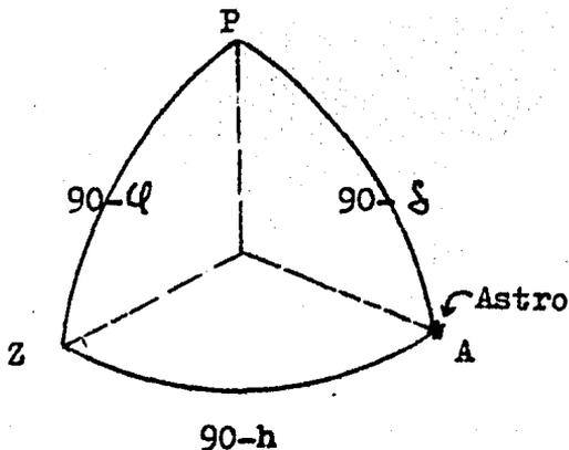
En la fig. V.w se observa el caso III de los triángulos esféricos oblicuángulos, cuya solución es:
