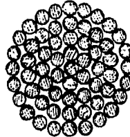
CABLE DE 61 HILOS
