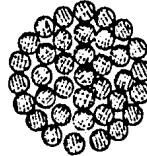
CABLE DE 37 HILOS
