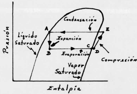
Fig. C.7 Diagrama presión-entalpía del Ciclo de Compresión (Carrier Corp.)
