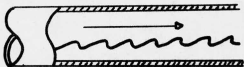
Flujo rizado u ondulado por el efecto de arrastre del vapor.
