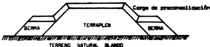
FIGURA Nº 6.- Terráplen con una carga de preconsolidación.
