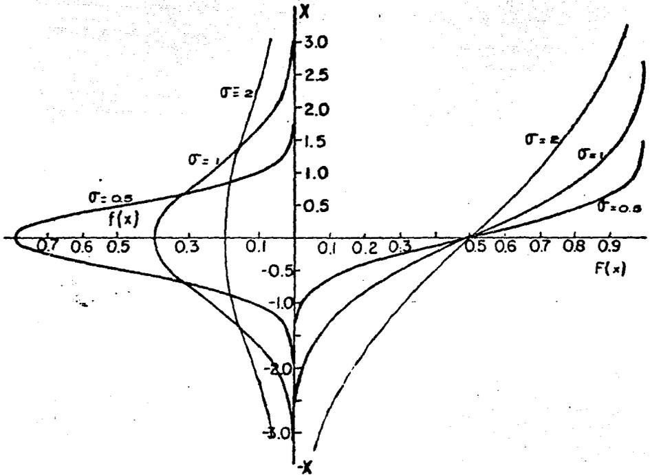
Fig. 3. Curva normal de densidad de probabilidad (lado izq. de la gráfica), y curva normal de distribución de probabilidad (lado der. de la gráfica) para  $\mu=0$  y tres valores de  $\sigma$ , 0.5, 1.0 y 2.0
