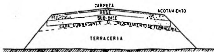
Sección típica de un pavimento flexible en terraplén
