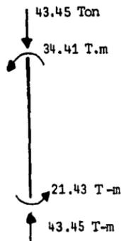
$h = 3.00\text{m}$  Sección  $b=t=55\text{ cm.}$   $d = 50\text{ cm.}$
