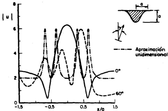
Fig 15. Amplitudes de los desplazamientos sobre la superficie libre para un depósito senoidal con  $\eta = 1.0$  y  $\gamma = 0^\circ, 60^\circ$
