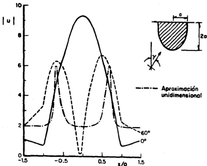
Fig 11. Amplitudes de los desplazamientos en la superficie libre para un depósito semielíptico
