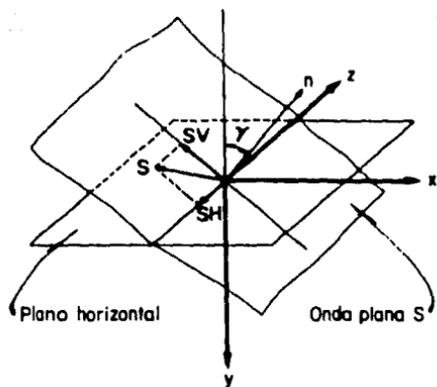
Fig 5. Frente de una onda plana de corte S y sus componentes horizontal SH y vertical SV
