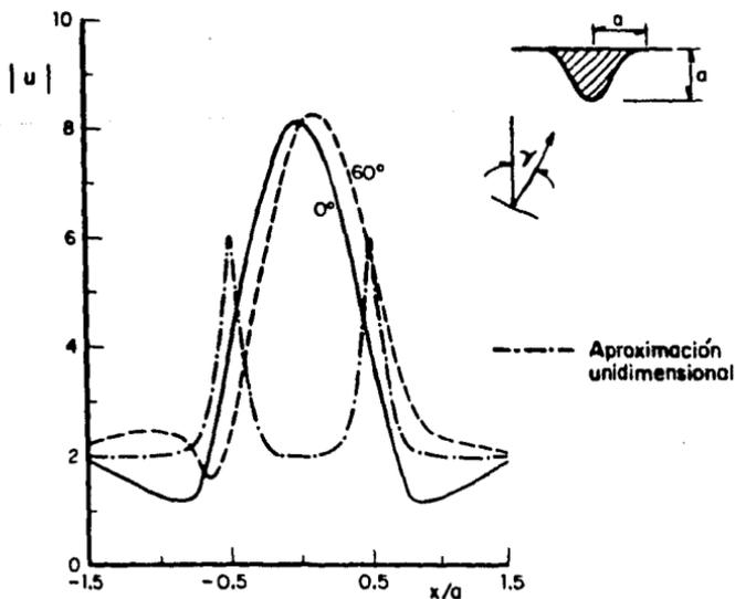
Fig 14. Amplitudes de los desplazamientos sobre la superficie libre para un depósito senoidal con  $\eta=0.5$  y  $\gamma=0^\circ, 60^\circ$
