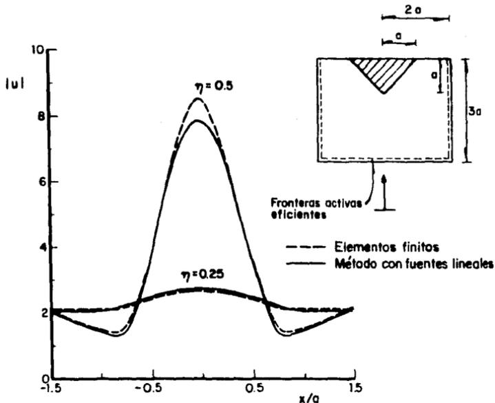
Fig 16. Comparación de las amplitudes obtenidas usando el método presentado y el análisis de elemento finito con las fronteras activas eficientes (Aranda y Ayala, 1978). Depósito triangular, incidencia vertical y  $\eta = 0.25, 0.5$
