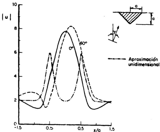
Fig 12. Amplitudes de los desplazamientos sobre la superficie libre para un depósito triangular con  $\eta = 0.5$  y  $\gamma = 0^\circ, 60^\circ$
