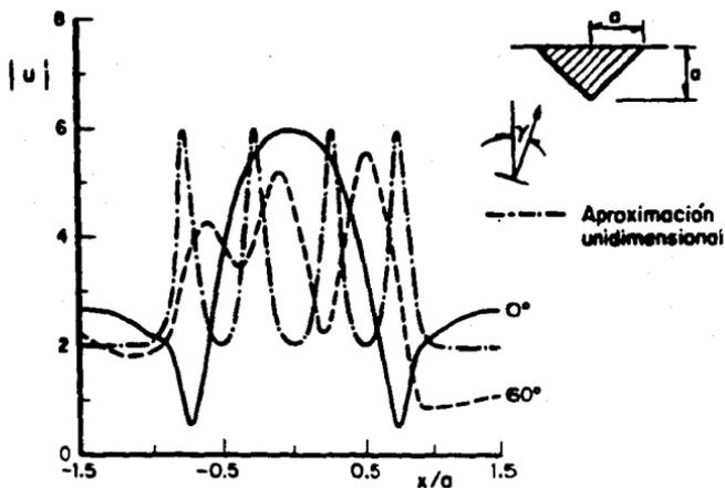
Fig 13. Amplitudes de los desplazamientos sobre la superficie libre para un depósito triangular con  $\eta=1.0$  y  $\gamma=0^\circ, 60^\circ$
