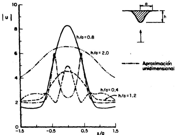
Fig 17. Amplificaciones de desplazamientos en la superficie libre de un depósito con sección senoidal con  $\lambda = 5h$  para  $h/a = 0.4, 0.8, 1.2, 2.0$
