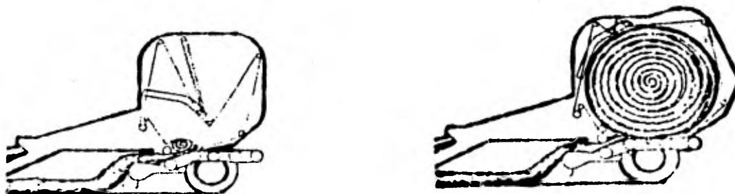
Figura 41. Proceso esquemático de embaladora tipo Vermeer.
