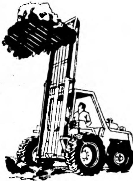
Figura 3. Montacargas de horquillas para terreno pesado con carga nominal de 2500 Kg.
