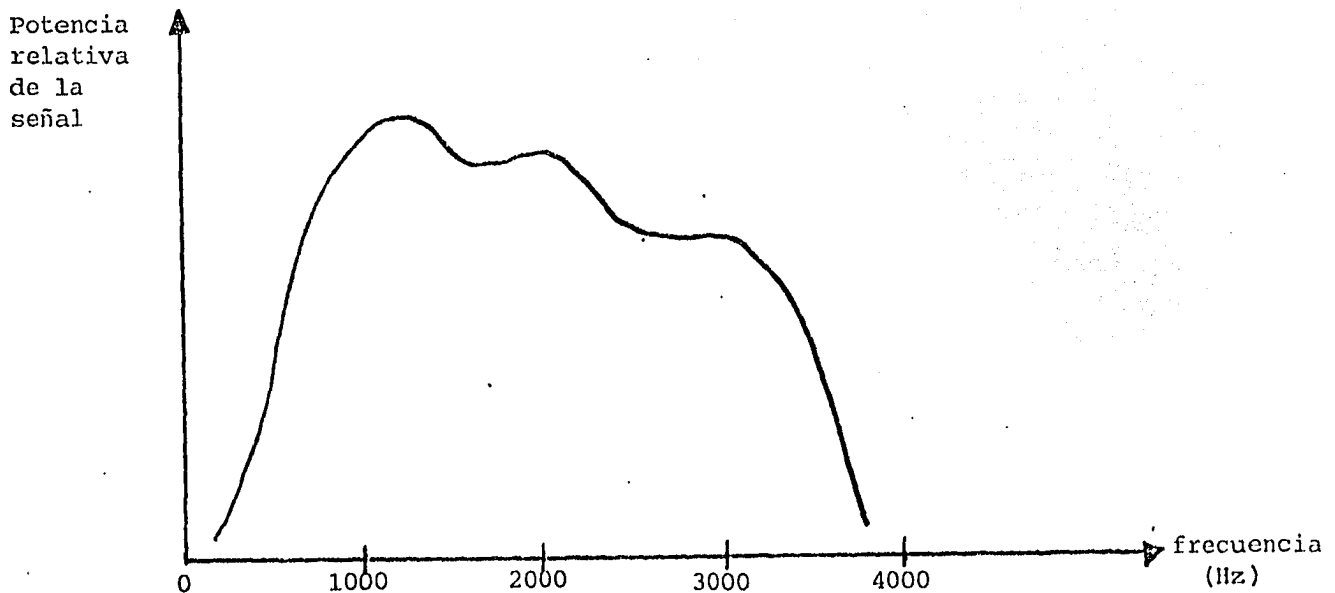
Curva característica de las líneas telefónicas acondicionadas.
