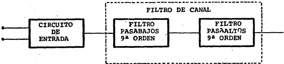
FIG. 4.2 ESQUEMA A BLOQUES DEL FILTRO DE CANAL
