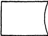
Se utiliza en conexión con todas las operaciones que tienen que ver con el almacenamiento de dispositivos (cintas, magnética, tarjetas perforadas o discos).
