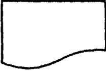
Se utiliza para denotar aquellas funciones de entradas y salidas que se originan a través de un documento.
