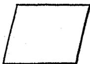
**Entrada-salida.** Para designar cualquier función de dispositivo de entrada o salida.
