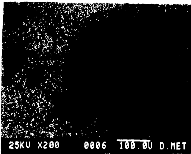
Foto # 17. Distribución de Silicio, (Si) , en el Cuarzo de la foto # 15.
