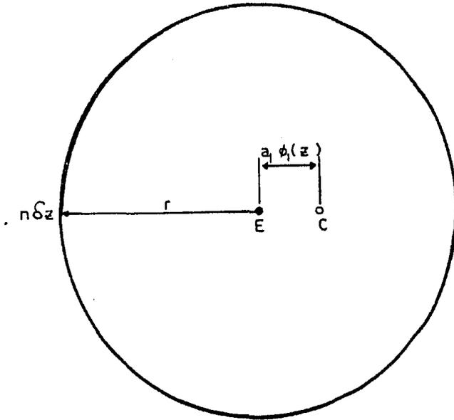
CORRECCION CON UNA SOLA MASA DE LA PRIMERA COMPONENTE DE LA EXCENTRICIDAD
