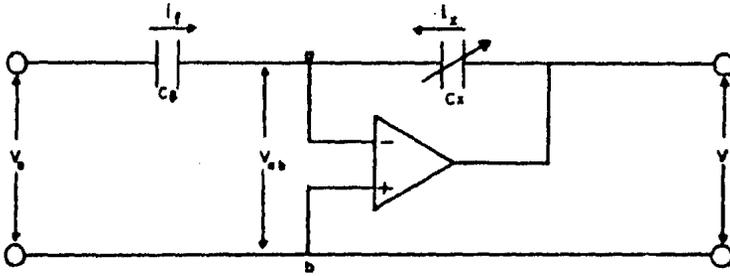
DETECTOR LINEAL DE POSICION DE TIPO CAPACITIVO
