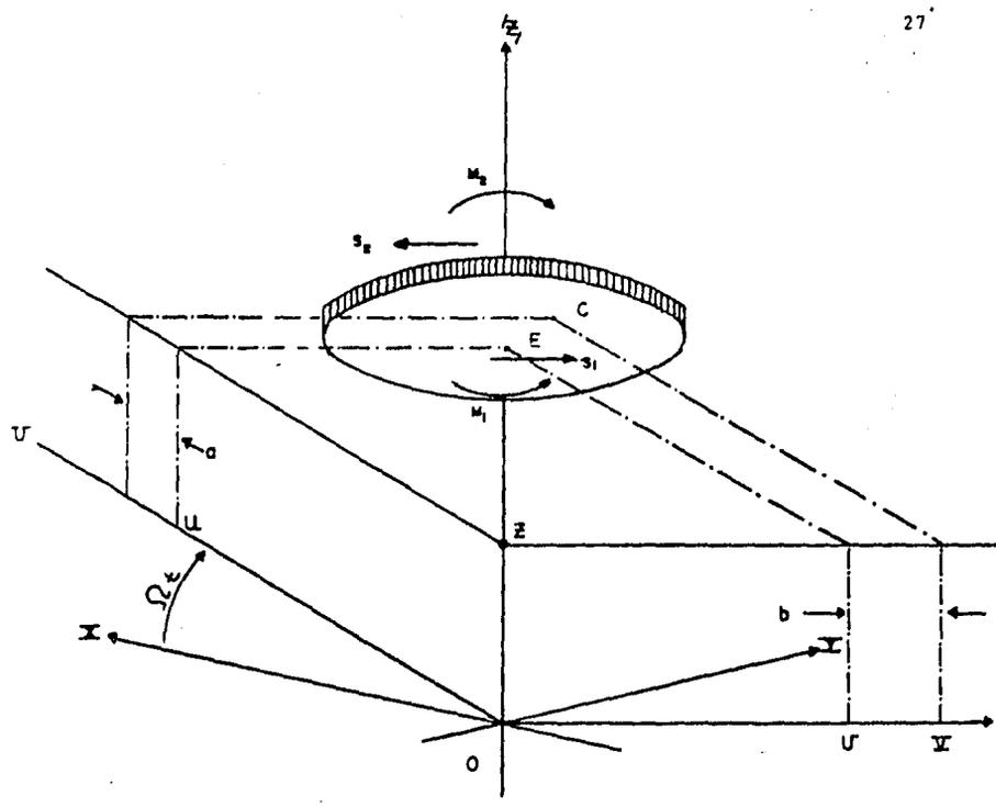
ELEMENTO TRANSVERSAL DEL ROTOR CON ESPESOR MUY DELGADO
