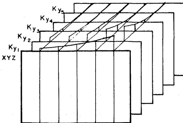
Figura II-10. Soluciones para varios números de onda  $K_{y_i}$  se integran para obtener  $\phi(x,y,z)$
