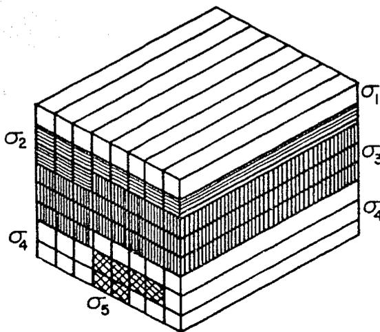
Figura 3. Variación de la conductividad en dos direcciones: con la profundidad y lateralmente (modelo bidimensional).
