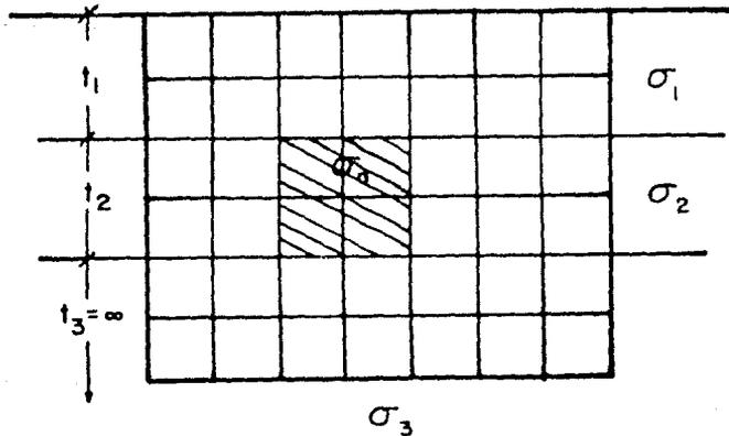
Figura II-4. Malla bidimensional dentro de un semiespacio estratificado.
