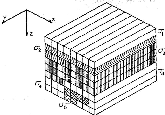
Figura I-6. Modelo de prismas infinitos con diferentes conductividades.
