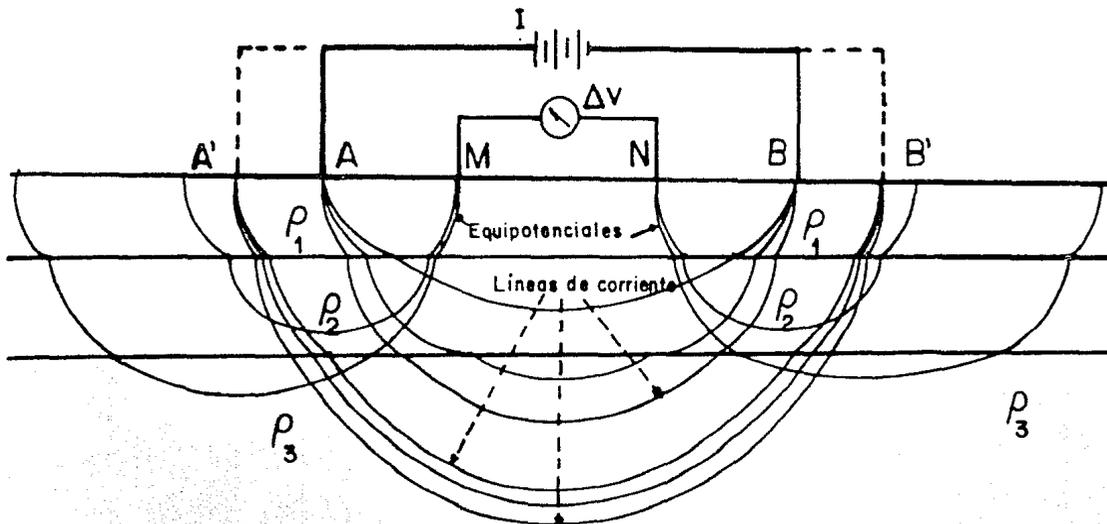
Figura I-2. a) Representación gráfica de la penetración de las equipotenciales al separar los electrodos de corriente. (En la figura  $\rho_1 < \rho_2$ ;  $\rho_2 > \rho_3$  ).
