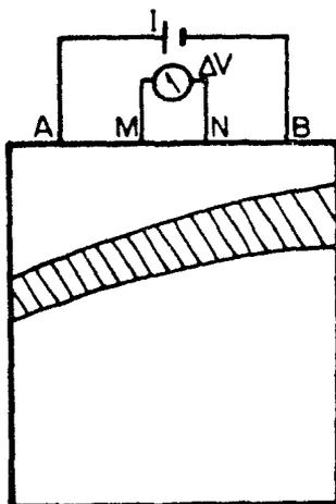
simulación de un estrato conductor en un medio homogéneo, pintado con tintura metálica.
