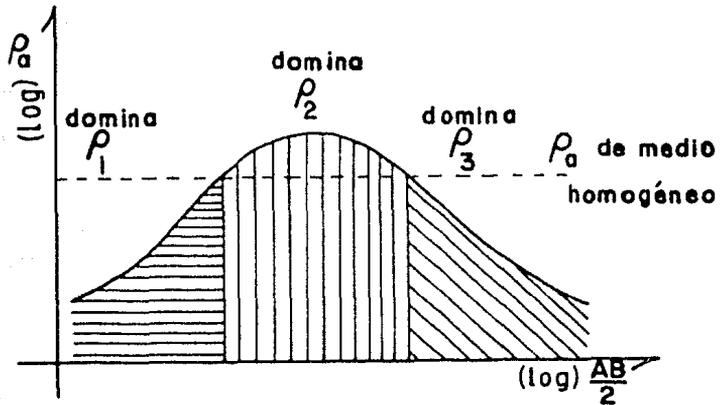
Figura I-2. b) Curva de VES que muestra la variación de  $\rho_a$  al ir penetrando más la corriente en el subsuelo.
