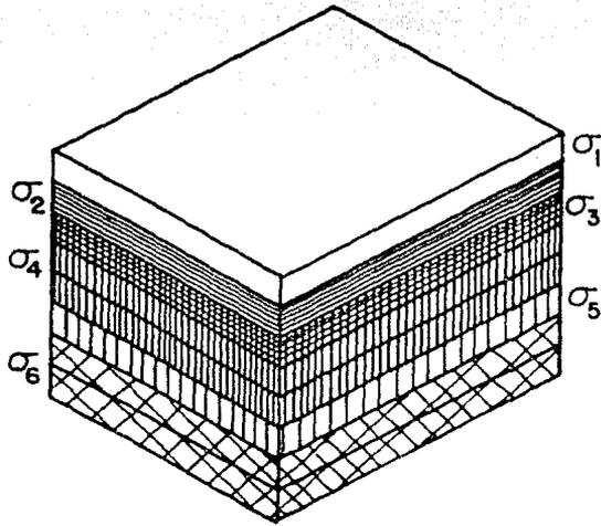
Figura 2. Variación de la conductividad con la profundidad (modelo unidimensional).
