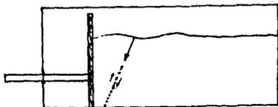
Fig. 11-b. Vista lateral de la cuba, se observa cómo se "rompe" el material de arriba hacia abajo, conforme continúa el empuje. Detalle: movimiento aparente de los granos al pasar la fisura en su vecindad.
