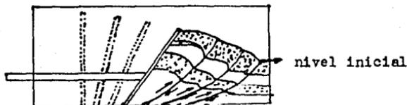
Fig. 13. Aspecto que presenta el material al final del experimento, mostrando una serie de acunamientos, producidos por empujes laterales de la placa inclinada sobre el material.
