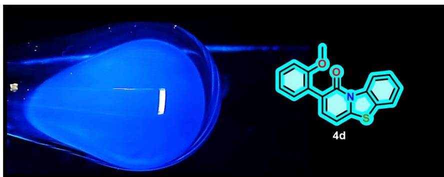
Figura 45 Luminiscencia del 2-(2-metoxifenil)-1H-benzo[4,5]tiazolo[3,2-a]piridin-1-ona **4d** disuelta en  $\text{CH}_2\text{Cl}_2$  observado bajo la lampara de UV-Visible a 364 nm.
