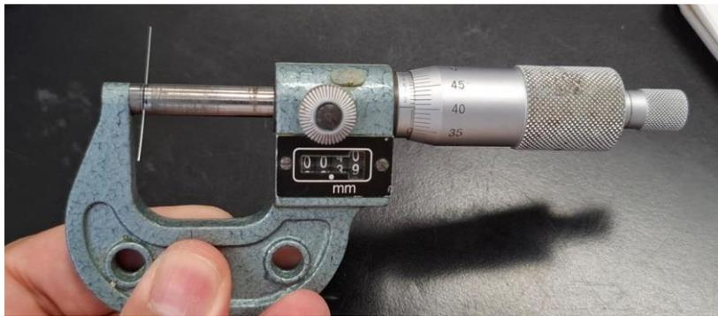
*Fig.16. Prueba con tornillo micrométrico en arco NiTi de la marca Ormco®. Imagen propia.*
