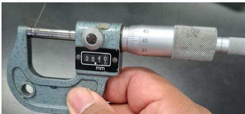
*Fig.17. Prueba micrométrica en arco NiTi de la marca American Orthodontics®*
