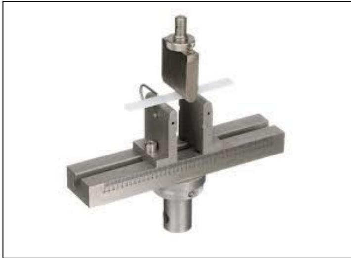
*Fig. 4. Imagen de los accesorios para la prueba de 3 puntos de la maquina INSTRON, obtenida de internet <sup>4</sup>.*
